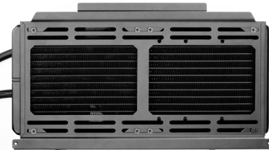
ラジエーターをラジエーター用サイドマウントブラケットに固定します。
