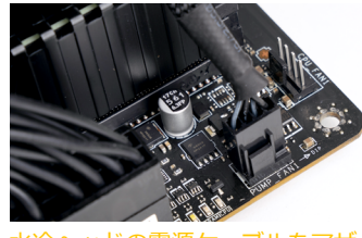
水冷ヘッドの電源ケーブルをマザーボード側の「PUMP FAN」ヘッダーに接続します。
