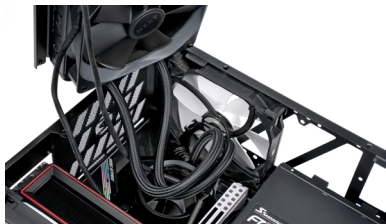
チューブを水冷ヘッドに巻きつけながら、ラジエーターをフレームに収めます。
