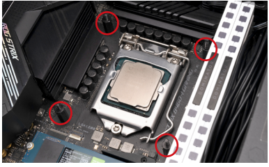
水冷ヘッドの金具を設置します。
