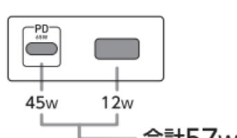
※ポート同時使用の際、ポート間での電力配分調整のため、一時的に出力が停止する場合があります。数秒後に再開しますが、再開しない場合はケーブルの抜き差しをお試しください。
